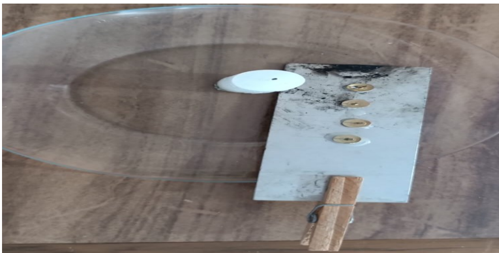
Figura 2.1 – Foto do metal com os percevejos fixados ao longo de uma de suas extremidades
