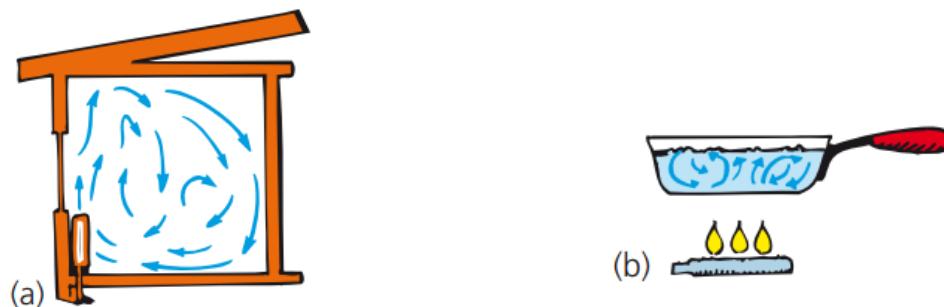
Figura 2 - (a) Correntes de convecção no ar. (b) Correntes de convecção em um líquido.
