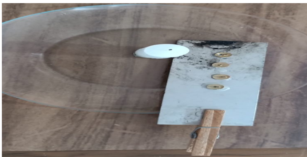
Figura 2.1 – Foto do metal com os percevejos fixados ao longo de uma de suas extremidades
