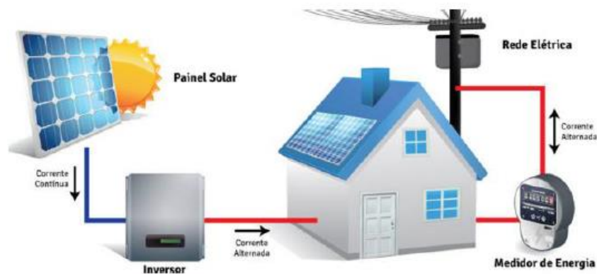
Figura 4 - Esquema de um Sistema Fotovoltaico Conectado à Rede. Fonte: Gerasol (2017).
