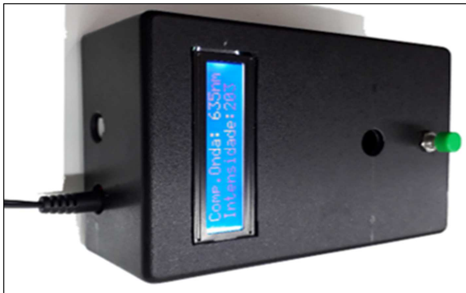
Figura 3.11: Imagem do fotômetro desenvolvido para o produto educacional proposto nesse trabalho, com detalhe para a posição do módulo LCD, da chave tátil, do furo para entrada do tubo de coleta e os furos de conexão USB e da fonte de alimentação. Fonte: arquivo pessoal do autor [26].
