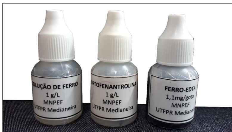
Figura 5: Solução padrão de Fe 2+ (1g/l), solução padrão de ortofenantrolina (1 g/l) e soluções padrões de Fe-EDTA (1,1 mg/gota).
