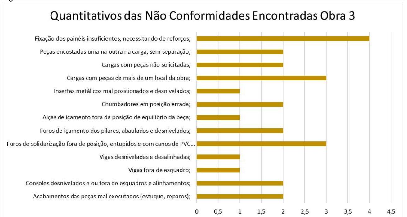
Figura 28 - Gráfico com as Não Conformidades com maiores incidências encontradas na obra 3
