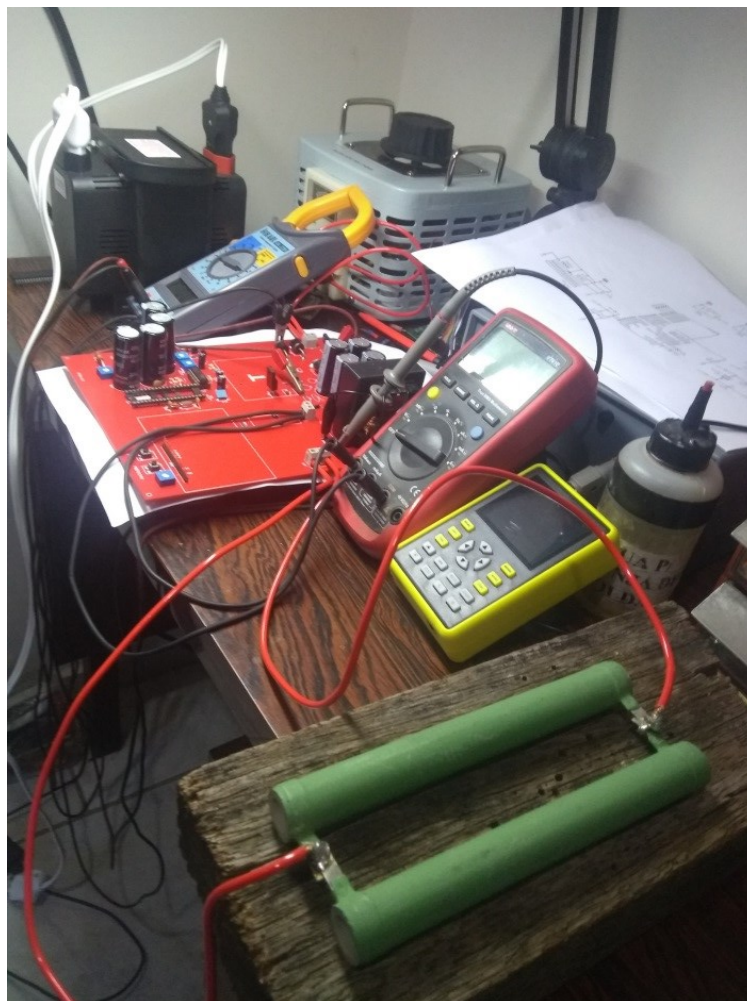
Figura 51 – Equipamentos e placa para a medição
