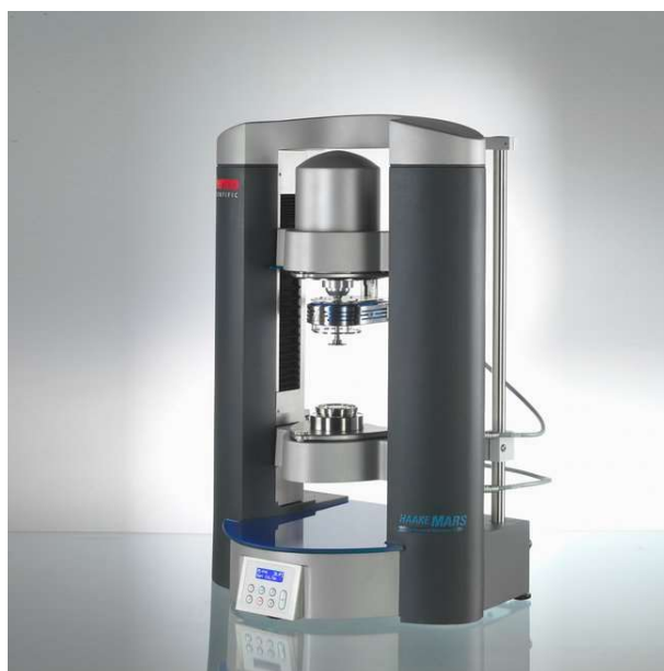
Figura A.1 – Reômetro utilizados na medição das propriedades reológicas dos fluidos de trabalho
