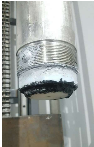
Figura 3.12 – Tampa de nylon instalada no fundo da coluna para evitar o influxo do fluido de trabalho.
