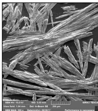
Figura 31 - MEV do filme de Perovskita depositados por mergulho depositados sobre vidro e tratados termicamente
