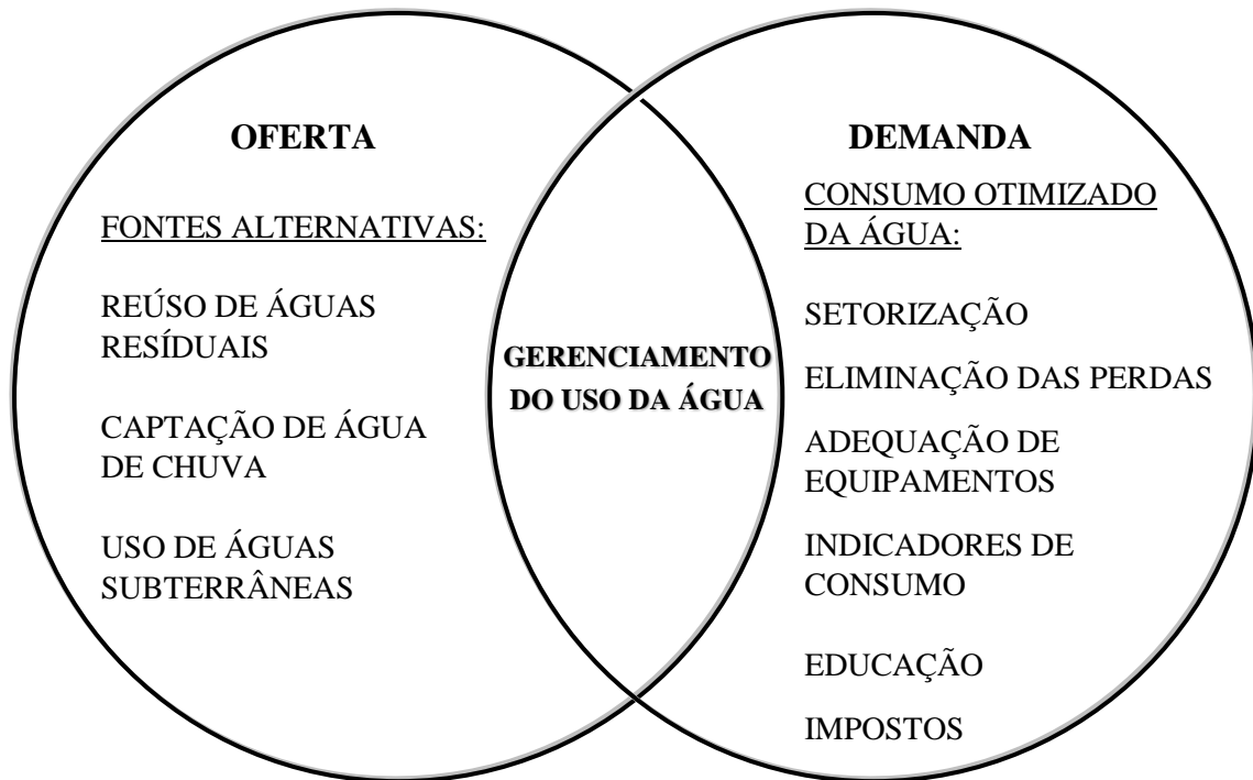
Figura 1: Conservação e gerenciamento da água.
