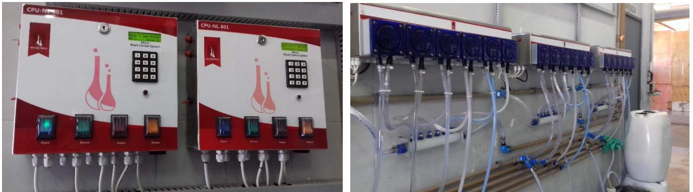
Figura 22: Processo automatizado de lavagem. a) Painel de controle. b) Dosagem de produtos inseridos em cada etapa.
