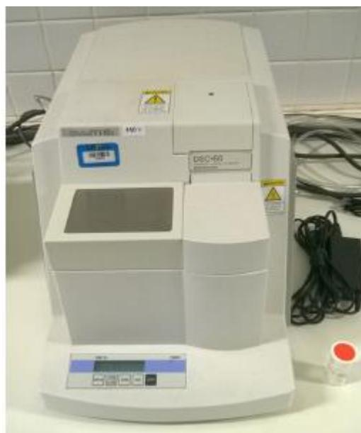
**Figura 9 - Calorimetria exploratória diferencial da Shimadzu DSC 60**
