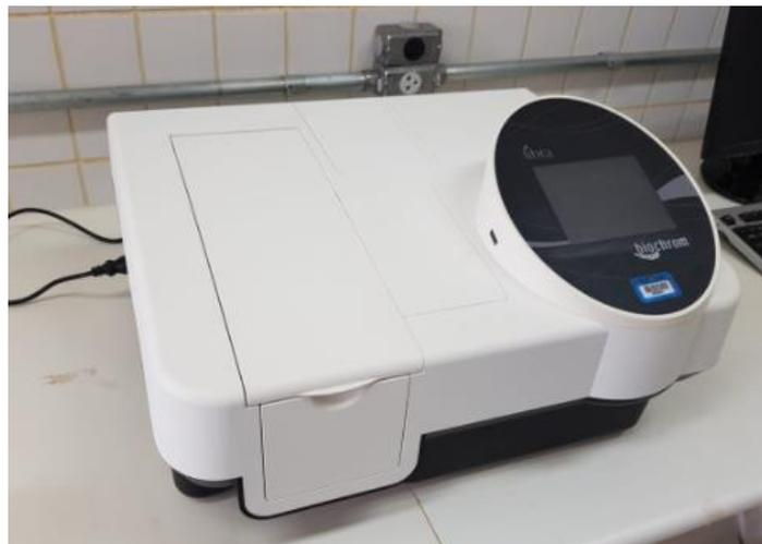
**Figura 11 - Espectrofotômetro de Absorção óptica Biochrom modelo Libra L60**
