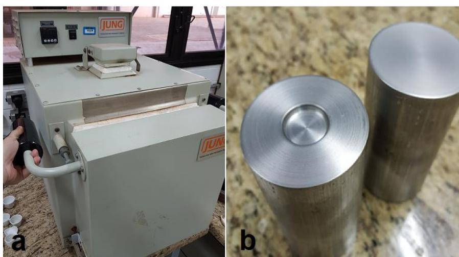
Figura 16 – a) Forno mufla da marca Yung. b) Molde de alumínio utilizado na fusão dos vidros
