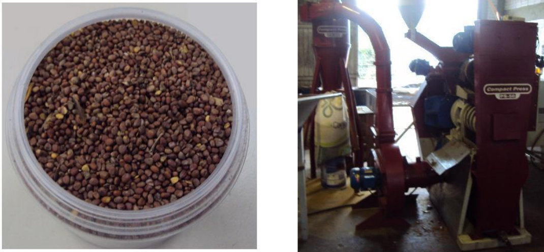
Figura 9 Grãos e filtro prensa utilizados para obtenção do óleo de nabo forrageiro. Fonte: Própria
