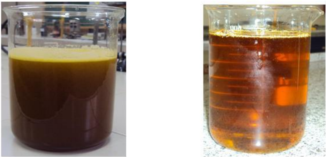
Figura 10 Óleo de nabo forrageiro (a) após prensagem; (b) após repouso 24 horas. Fonte: Própria
