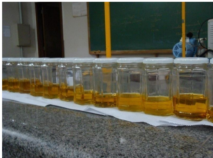
Figura 13 Resultados dos experimentos com catalisador NaOH e KOH. Fonte: Própria
