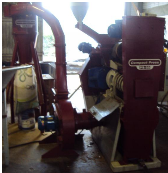
Figura 19 Prensa mecânica, para extração de óleo de nabo forrageiro. Fonte: Própria.
