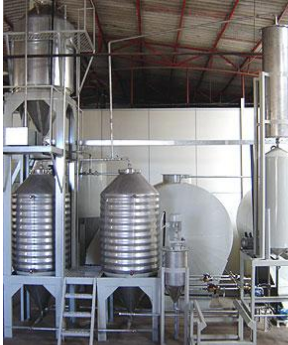
Figura 20 Reator para produção de biodiesel e recuperação de álcool. Fonte: Própria.
