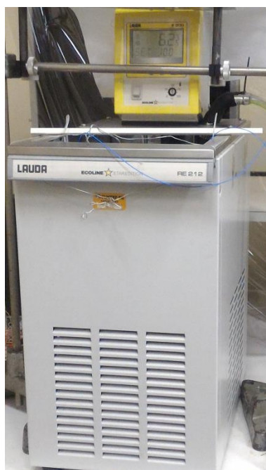
Figura 19 – Equipamento utilizado para caracterização do sensor em temperatura. Autoria Própria.
