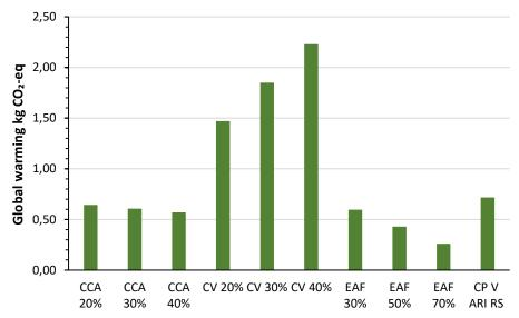
Figura 14 - Emissão de dióxido de carbono (kg CO<sub>2</sub>-eq) por tipo de adição
