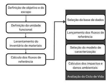
Figura 3 - Esquema geral de funcionamento da Avaliação do Ciclo de Vida
