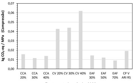
Figura 16 - CO<sub>2</sub>-eq por unidade de Resistência (MPa) na compressão
