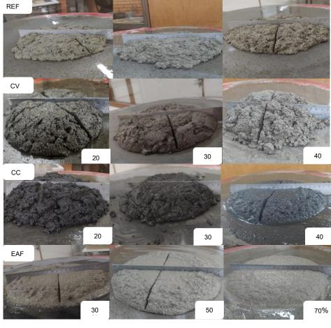
Figura 12 - Ensaio de consistência das misturas
