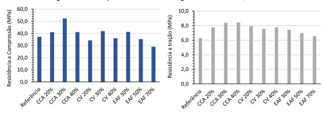
Figura 13 - Desempenho Mecânico das Argamassas com CCA, CV e EAF
