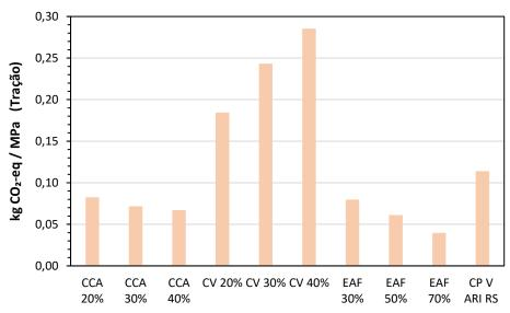
Figura 15 - CO<sub>2</sub>-eq por unidade de Resistência (MPa) na tração
