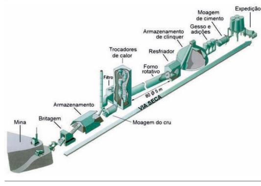
Figura 1 - Esquema do processo produtivo do cimento
