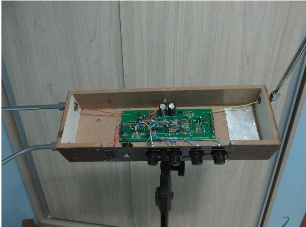
Fotografia 4 - Theremin de Campo Eletromagnético com circuito à mostra
