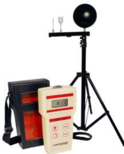
Figura 9 – Termômetro de Globo TGI 01 - Instrutemp Fonte: Central Brasil Instrumentos, 2018
