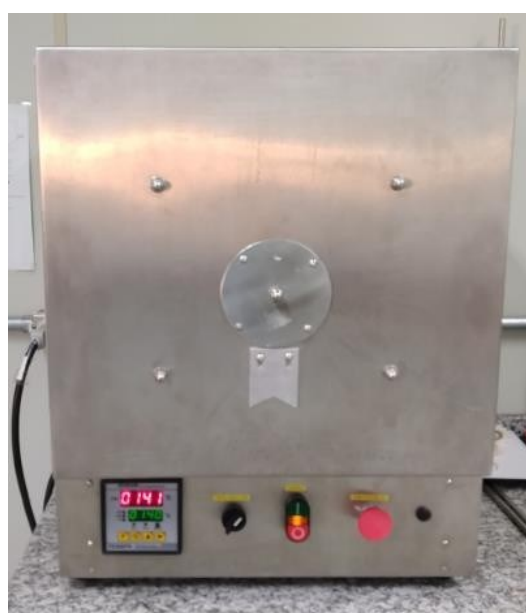
Figura 22 – Forno programável eletronicamente.
