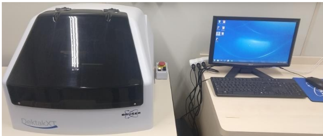
Figura 17 – Perfilômetro de contato marca Bruker®, modelo DektakXT Stylus .
