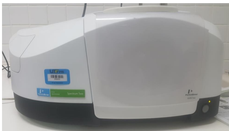
Figura 16 – Equipamento Espectrômetro de Infravermelho com Transformada de Fourier (FTIR).
