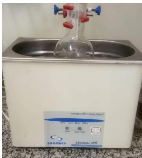
Figura 20 - Lavadora ultrassônica digital, marca Sanders ® , modelo SoniClean 2PS.
