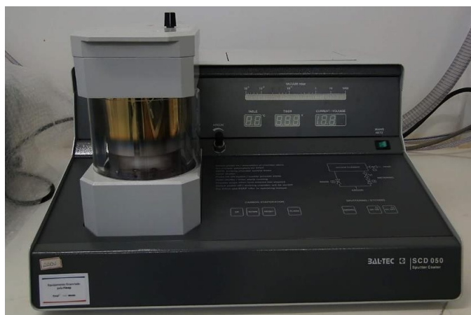
Figura 13 – Equipamento metalizador de amostras, marca Balt-tec , modelo SCD 050 Spritter Coater .
