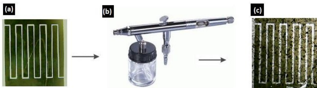
Figura 26 – Representação esquemática de deposição do filmes. (a) ID sem deposição. (b) caneta aerógrafo. (c) ID depositado.
