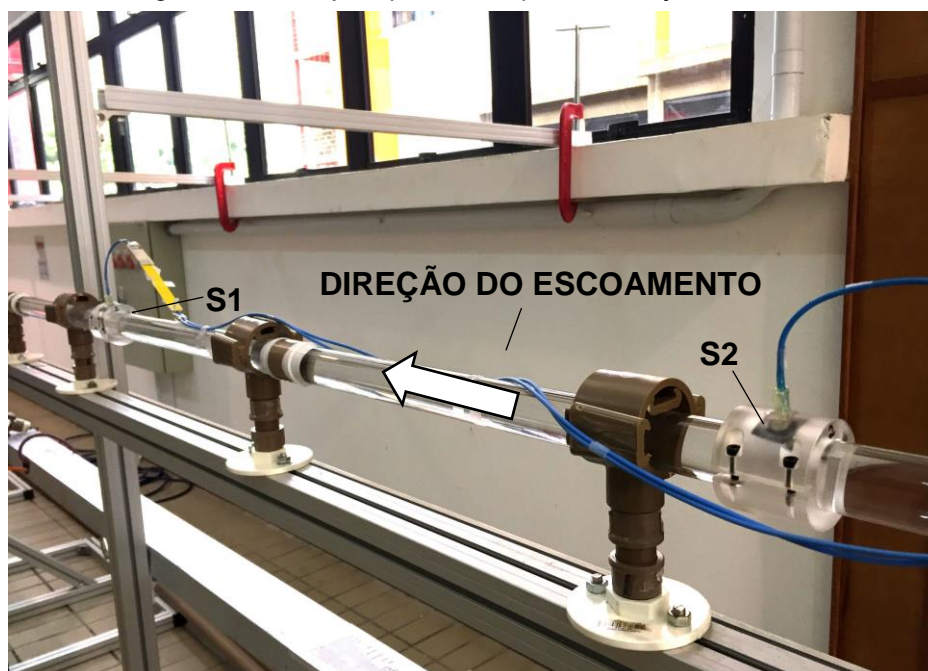
Figura 3-8: Arranjo experimental para calibração dinâmica
