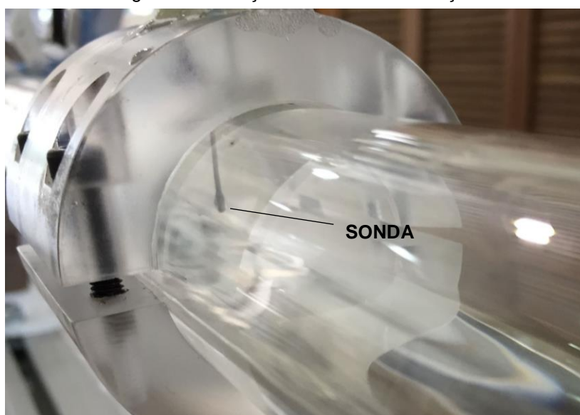
Figura 3-9: Posição da sonda na tubulação
