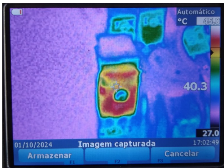
Figura 107 - Resultados experimentais com carga de 1 kW em malha aberta: temperatura no transistor S_3
