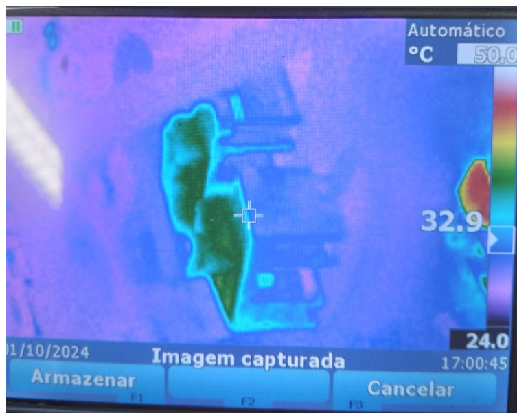
Figura 105 - Resultados experimentais com carga de 1 kW em malha aberta: temperatura no transistor S_1
