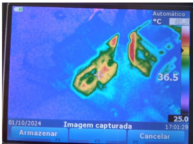
Figura 106 - Resultados experimentais com carga de 1 kW em malha aberta: temperatura nos diodos D_1 e D_2
