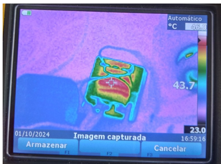
Figura 108 - Resultados experimentais com carga de 1 kW em malha aberta: temperatura no núcleo dos indutores acoplados
