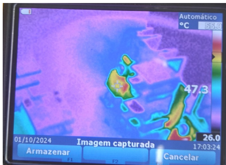
Figura 109 - Resultados experimentais com carga de 1 kW em malha aberta: temperatura nos diodos D_3 e D_4
