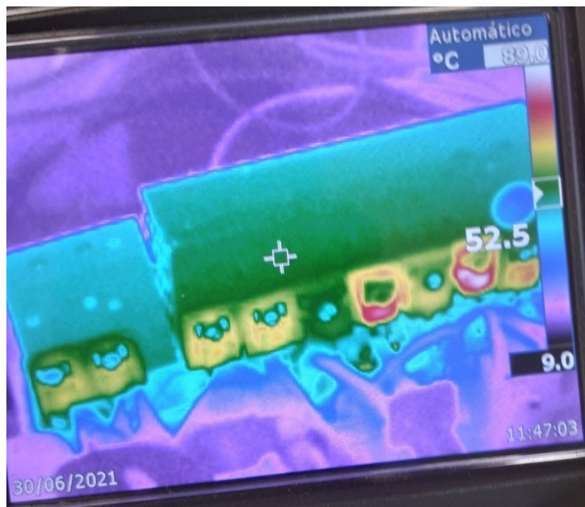
Figura 66 - Resultados experimentais no ponto de operação A: temperatura durante a operação com carga de 1 kW
