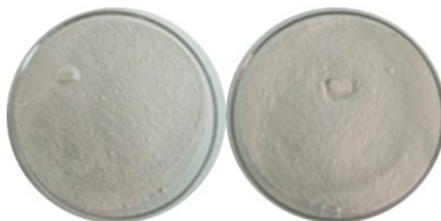
Figura 8 – Caulinita disposta em placa de Petri para secagem
