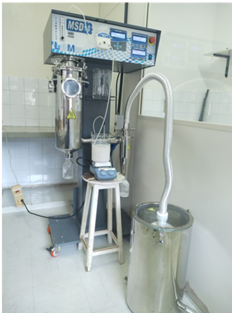
Figura 10 – Caulinita sendo processada no Spray Dryer sob agitação magnética para evitar aglomerados
