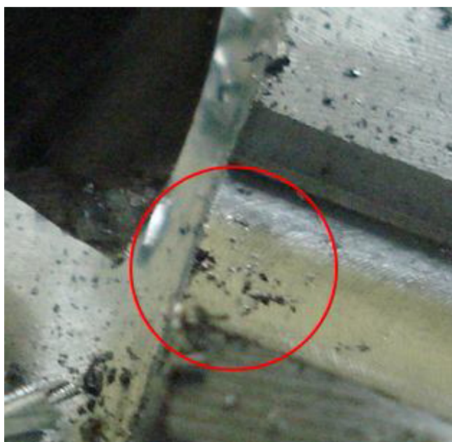
Figura 4.3 – Destaque nos vazios surgidos no ensaio de usinagem
