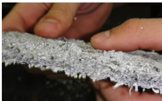
Figura 4.4 - Amostra de cavacos de zamac-8 após tentativa de fundição.
