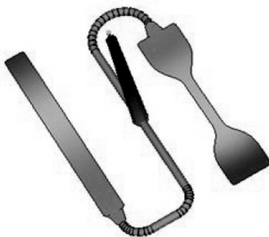
Figura 3.6 – Modelos CAD das cavidades, canais de injeção e bicos de injeção.
