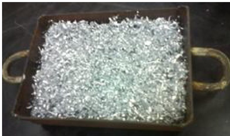
Figura 3.10 - Cadinho de aço utilizado para a fundição do cavaco de zamac-8.
