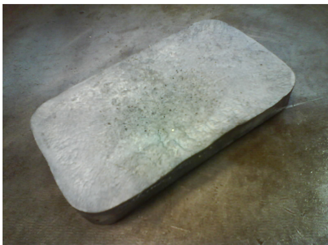
Figura 3.2 - Blanche fundido no laboratório de materiais da UTFPR, para ensaio de usinagem.
