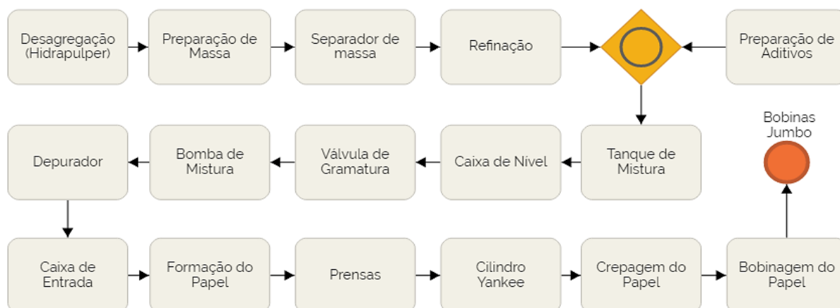
Figura 4 - Etapas do processo de fabricação de papel
