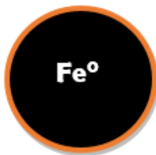
Figura 4 - Partícula de ferro recoberta por óxidos, estrutura core-shell.
