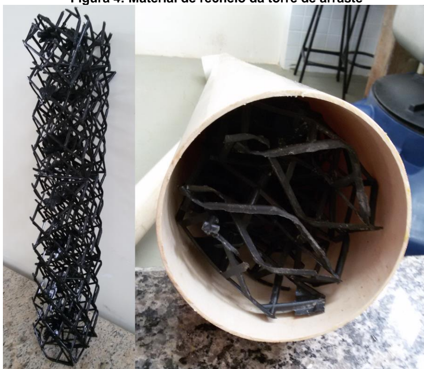
Figura 4: Material de recheio da torre de arraste
