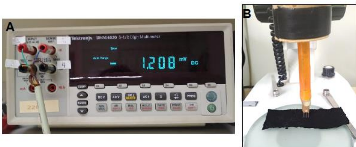
Figura 11: Equipamento utilizado para medição da resistência dos materiais através do método de quatro pontas. Em A) aparece uma imagem digital do multímetro e em B) da sonda quatro pontas.
