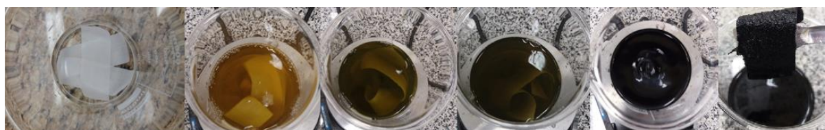
Figura 17: Síntese de polipirrol, via oxidação química do pirrol utilizando cloreto de ferro(III) hexahidratado, na presença de tecido de algodão. As imagens fotográficas mostram as mudanças de coloração sofridas pela solução durante a reação
