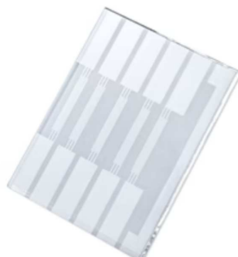
Figura 24 – Substrato de vidro/ITO pré-estruturado utilizado na fabricação dos dispositivos.
