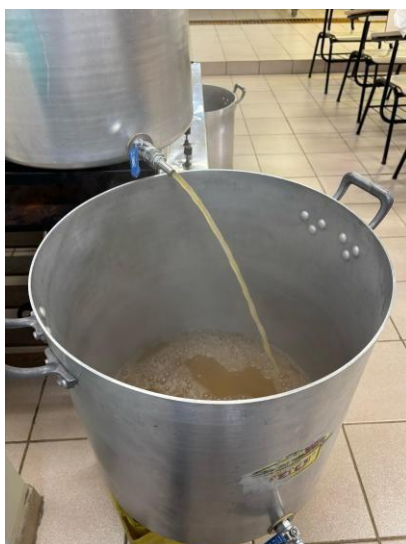
Figura 9: Processo de filtração do mosto
