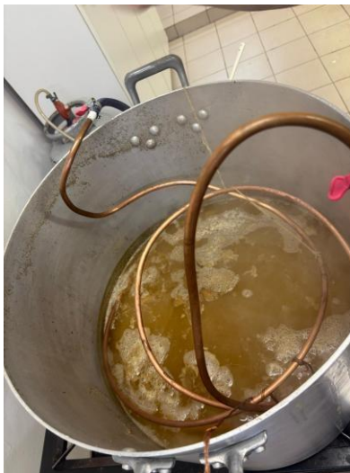
Figura 11: Tratamento do mosto (resfriamento)
