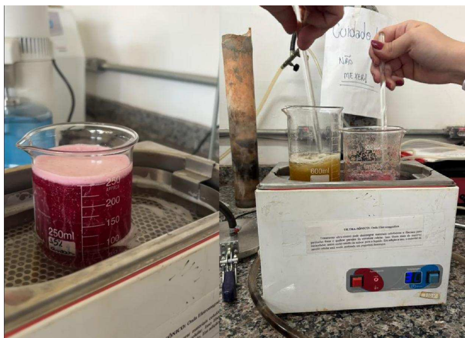
Figura 15: Processo de descarbonatação
