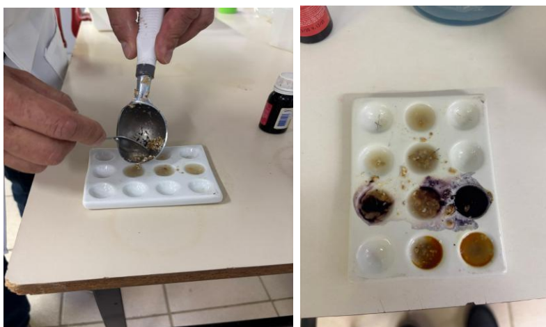
Figura 8: Teste do iodo
