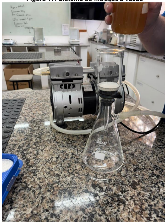
Figura 17: Sistema de filtração a vácuo
