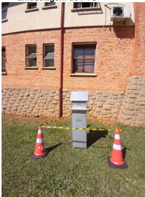
Figura 4 - Amostrador de Grande Volume controlador de vazão volumétrica cabeçote para amostragem de PTS
