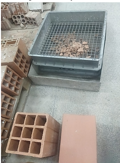
Figura 17 – Peneiramento dos fragmentos de tijolo cerâmico entre as malhas de 3/4" e 1"
