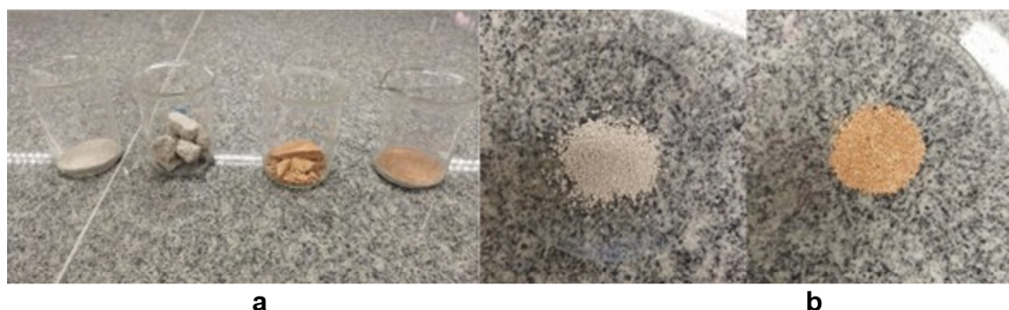
Figura 15 – Preparação dos RCC utilizados como suporte: (a) materiais in natura e (b) materiais após trituração e peneiramento (60 mesh, 0,25 mm).
