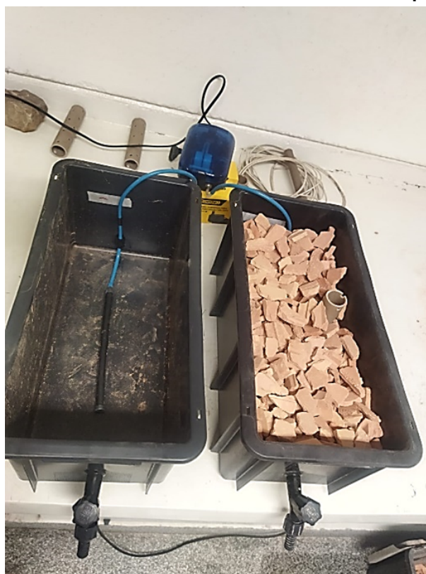
Figura 18 – Montagem das unidades de wetlands construídos com preenchimento de tijolo
