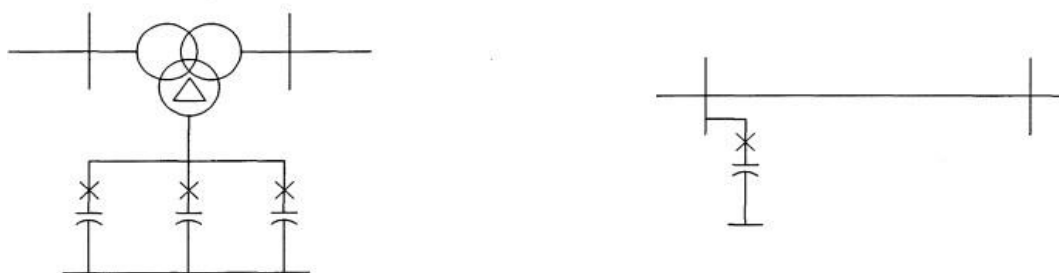
Figura 10: Capacitor Shunt Conectado ao Sistema de Transmissão
