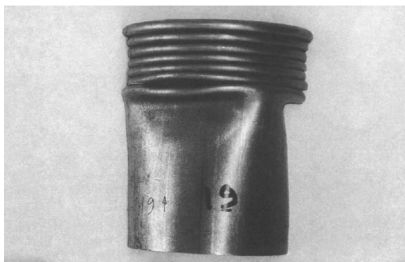
Figura 9 – Tubo deformado através de flambagem progressiva.
