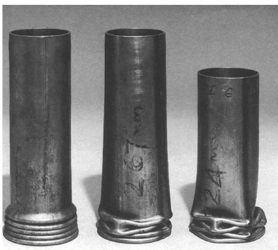
Figura 11 - Diferentes modos de flambagem progressiva (vista lateral). Fonte: Jones (1997).
