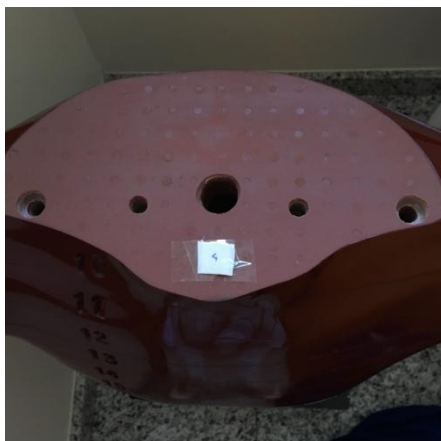
Figura 26 - Dosímetro posicionado na tireoide
