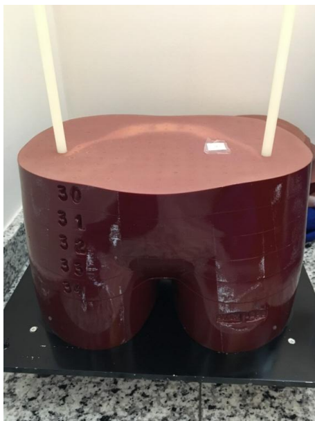
Figura 28 - Dosímetros posicionados na região das gônadas feminina
