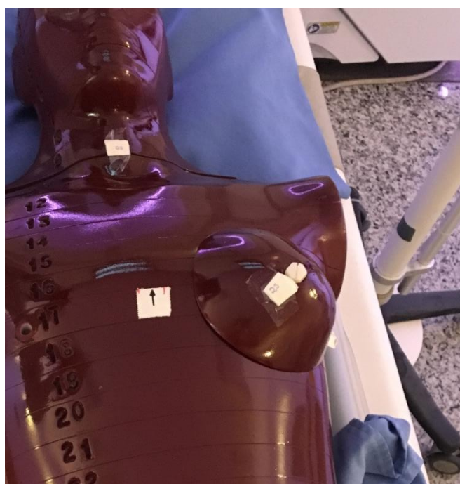
Figura 27 - Dosímetros posicionados na região das mamas
