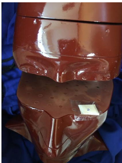
Figura 25 - Dosímetros posicionados no cristalino
