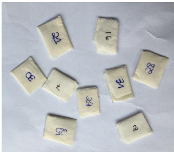
Figura 22 - Dosímetros agrupados em pares numerados
