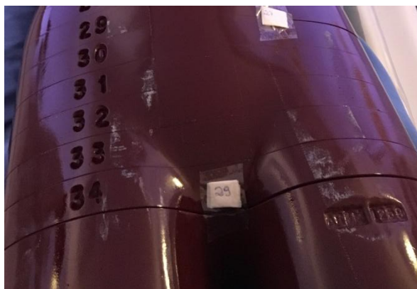
Figura 29 - Dosímetros posicionados na região das gônadas masculina
