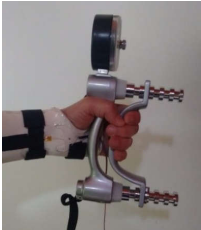
Figura 27. Teste de prensão e deformação das órteses.
