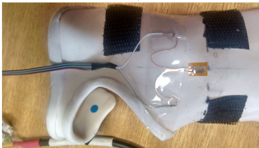
Figura 23. Posicionamento do SG na órtese de Omega™ Max.
