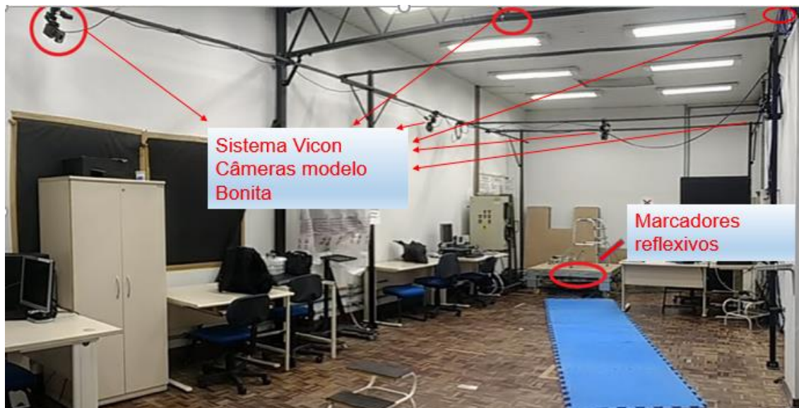
Figura 10 - Sistema de câmeras modelo Bonita e marcadores reflexivos na plataforma móvel.
