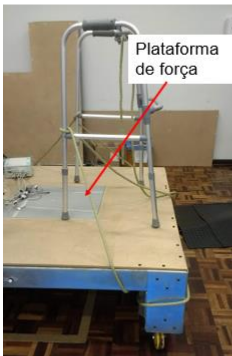
Figura 8 - Plataforma de força modelo OR6-7AMTI, marca Advanced Mechanical Technology Inc. , AMTI.
