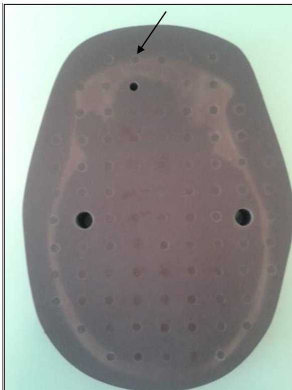
Figura 8: Phantom Antropomórfico ART: Cavidades Internas para dosímetros. Fonte: Autoria Própria
