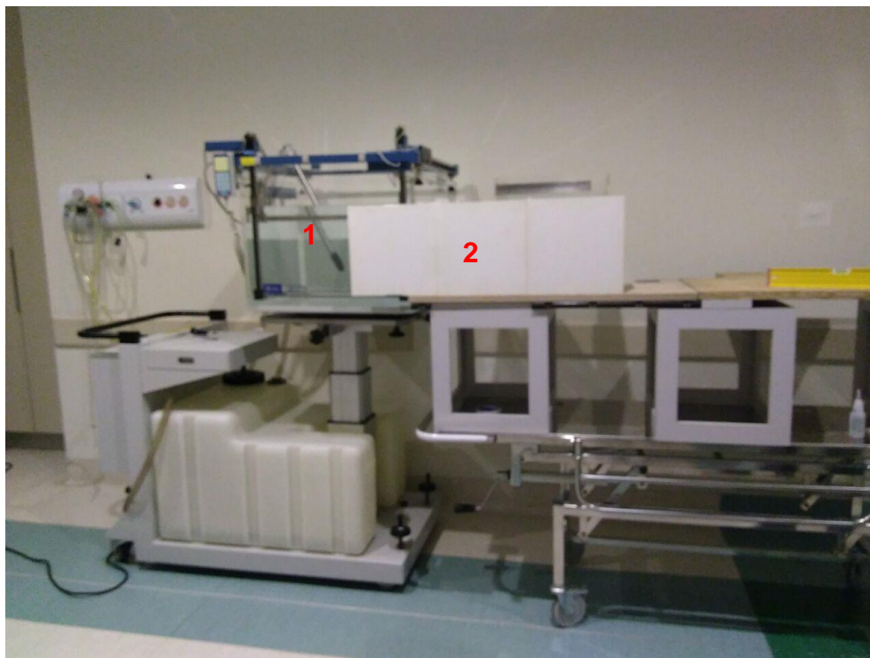
Figura 20: Obtenção das medidas das curvas de PDP, com filmes radiocrômicos. (1) Phantom de água (2) Placas paralelas com filmes radiocrômicos, entre elas. Fonte: Autoria Própria.
