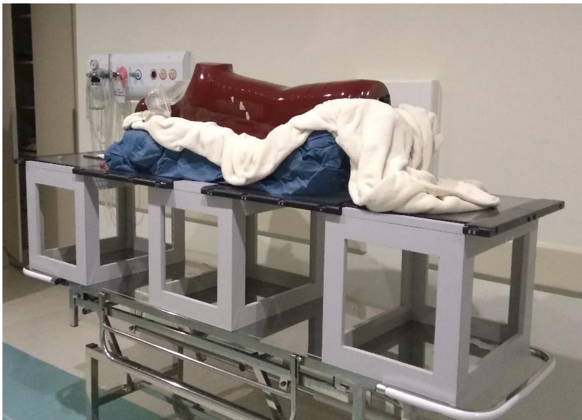
Figura 23: Phantom no acessório de imobilização. Em posição de simulação de tratamento. Autoria Própria.
