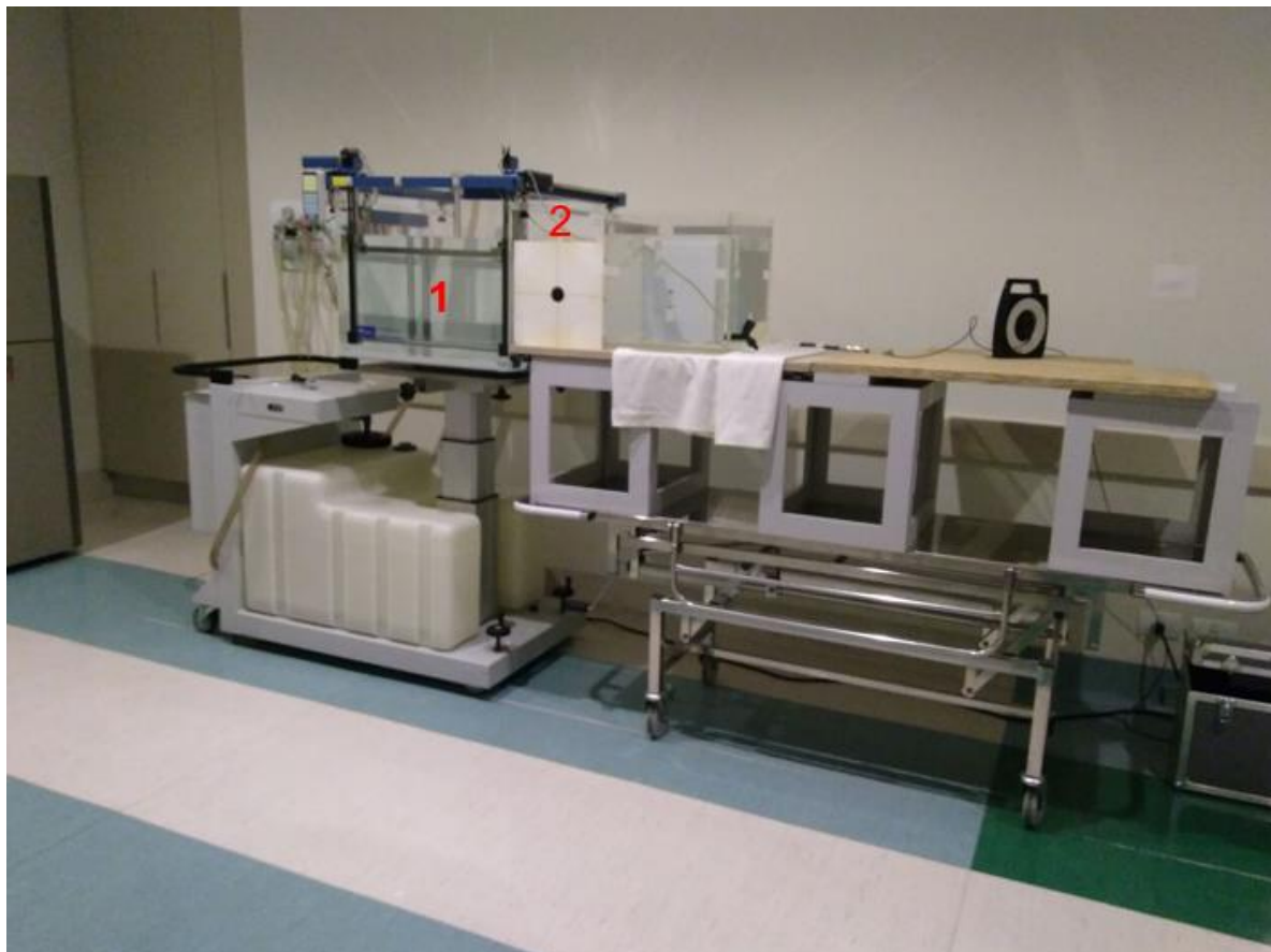
Figura 19: Obtenção das medidas das curvas de PDP com câmara de ionização. (1) Phantom Wellhofer (IBA USA - Virginia, Estados Unidos) (2) Câmara de ionização sanduichada nas placas de água sólida.
