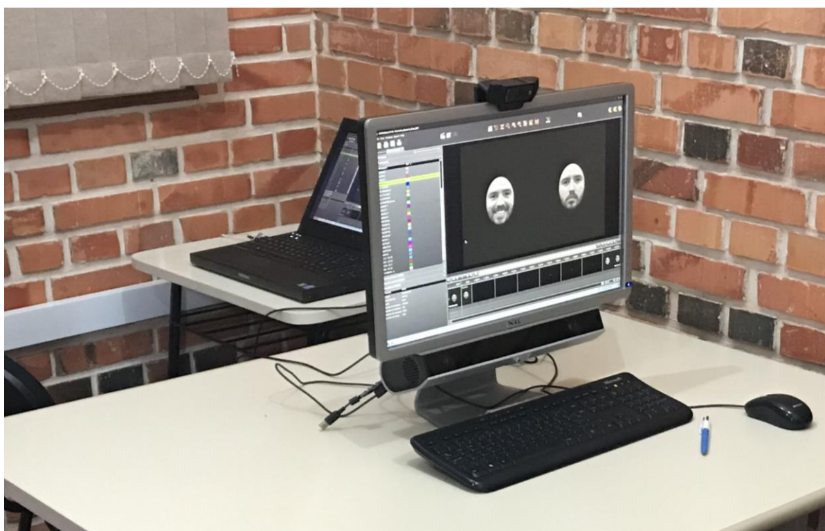
Fig. 1 - Equipamento Eyetracker utilizado: Monitor com eyetracker acoplado na parte inferior e notebook. Fonte: Autoria própria.
