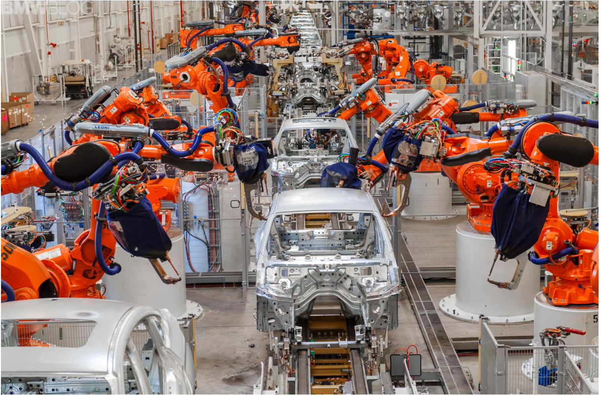
Figura 1.1: Aplicação de solda ponto em uma zona final do setor de carroceria.
