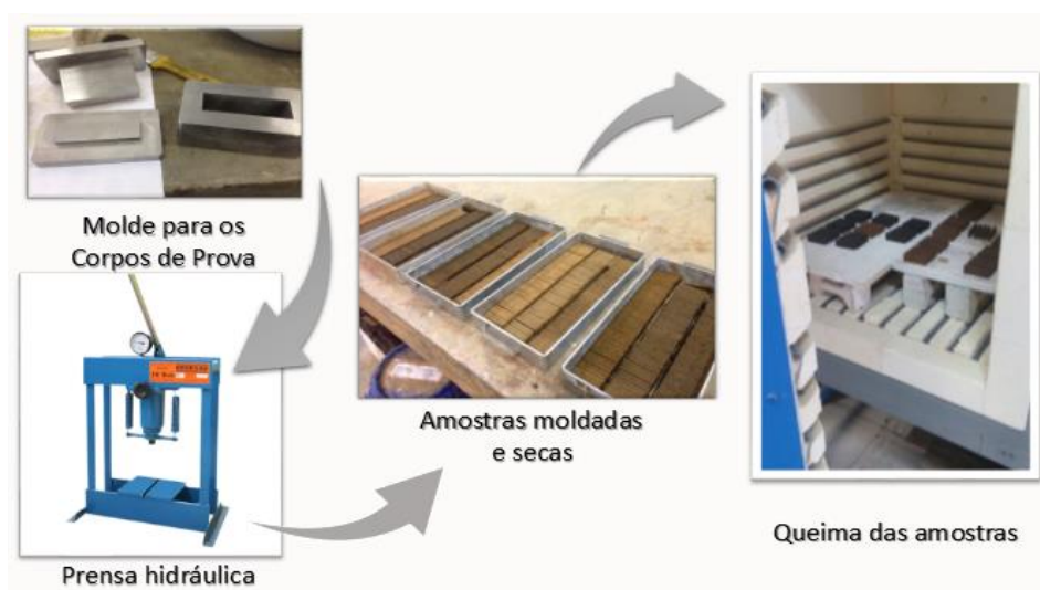
Figura 27 –Etapas para confecção de corpos de prova cerâmicos: Moldagem até queima.
