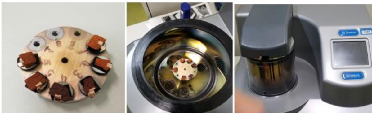
Figura 9 - Procedimento de preparo de amostras com recobrimento em ouro. Fonte: A AUTORA (2018)
