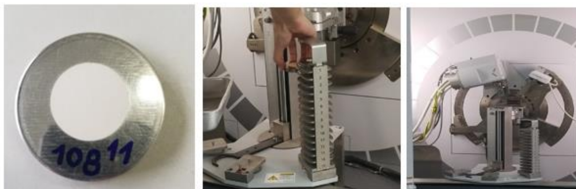
Figura 8 - Esquema prático amostra e difratômetro. Fonte: A AUTORA (2018)
