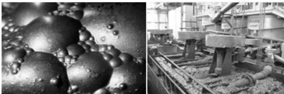
Figura 4 - Sulfeto de chumbo nas bolhas de flotação e célula de flotação Fonte: SOBRAL et al. , 2012
