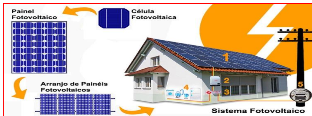
Figura 27: Esquema de como ocorre o funcionamento do painel solar 52 .
