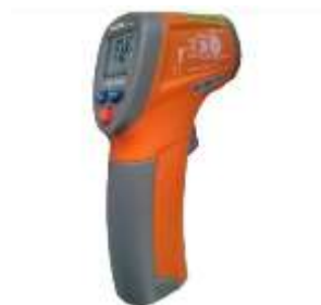
Figura 34 – Termômetro para medição da temperatura superficial.
