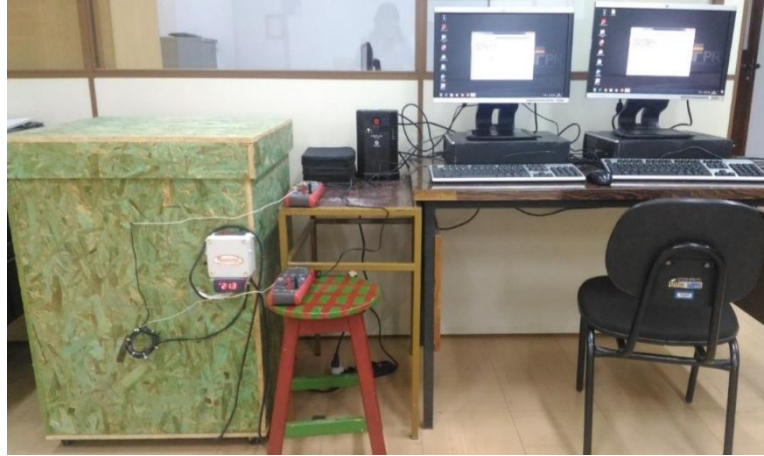
Figura 26 - Estrutura para ensaio com Câmara “Prohélios”. Fonte: Autora (2018)
