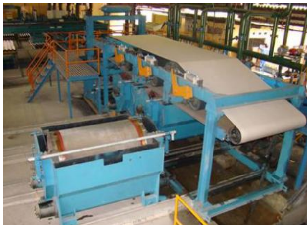
Figura 6- Máquina de Hatschek moderna Fonte: Martins (2018)
