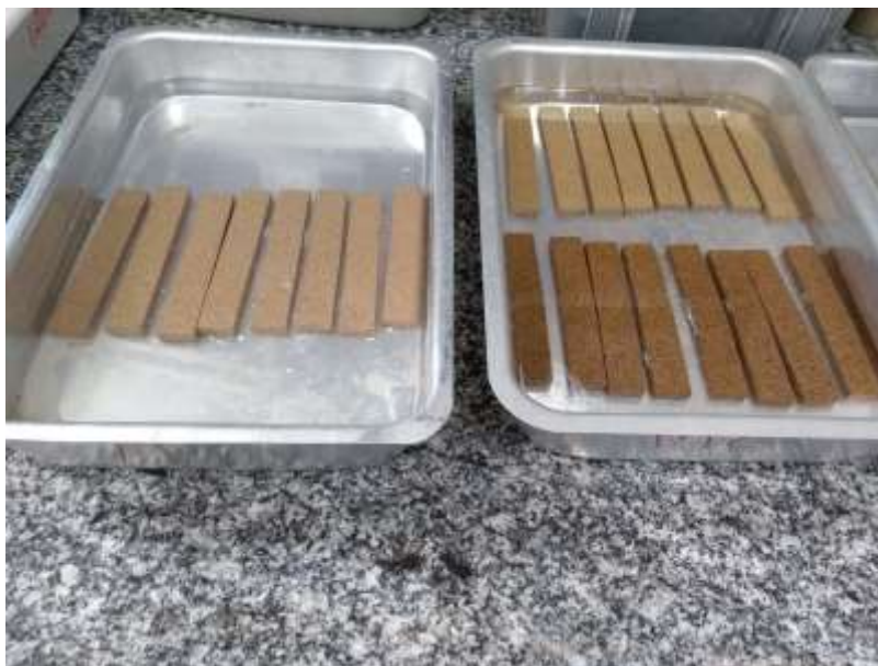
Figura 19: Corpos de prova M2 em imersão
