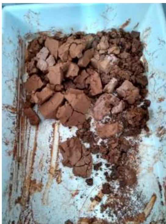
Figura 12: Lodo após o desague e seco ao ar
