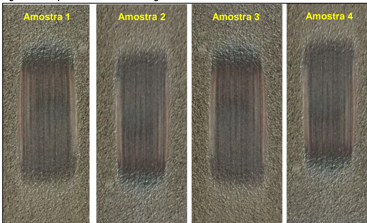
Figura 28 - Aspecto das marcas de desgaste das amostras CP1.
