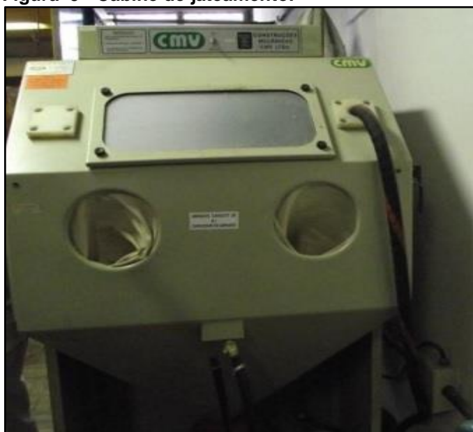
Figura 9 - Cabine de jateamento.
