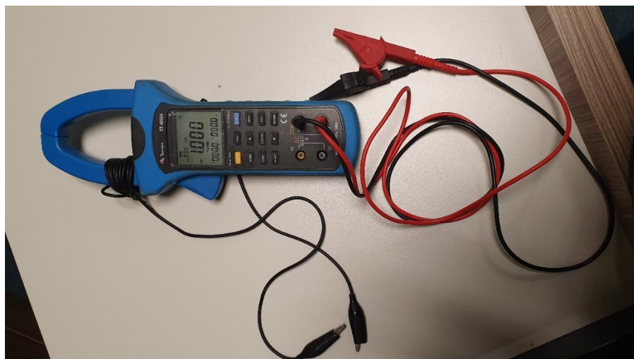
Figura 16 - Alicate wattímetro Minipa ET-4055A com 10 volts do condutor no alicate.
