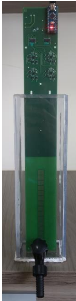
Figura 3.17 – Reservatório para calibração do sensor de nível.
