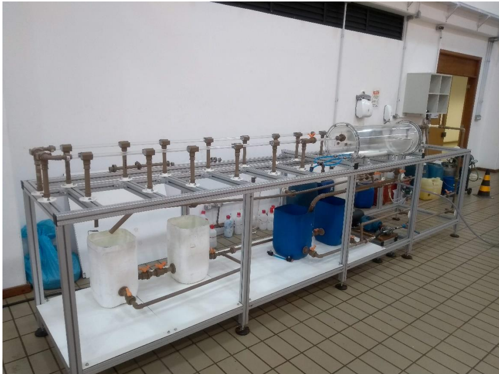
Figura 3.3 – Bancada experimental do protótipo do separador da UTFPR.
