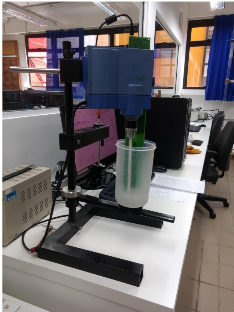
Figura 4.16 – Misturador produzindo emulsões simultaneamente à medição do sensor de nível.
