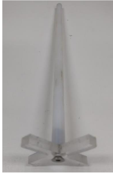
Figura 4.9 – Impeller de plástico e acrílico utilizado para produzir as emulsões.
