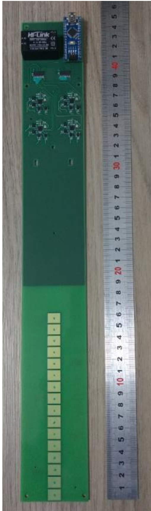
Figura 3.16 – Protótipo final do sensor de nível desenvolvido.
