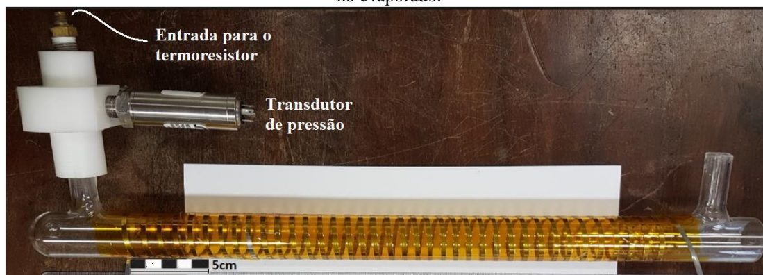
Figura 18 – Detalhes da montagem do resistor em forma de fita e dos orifícios para a instalação do termoresistor no evaporador
