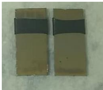
Figura 7: Imagens das amostras demarcadas para área exposta fixa utilizando o tubo termoretrátil de borracha de 6 mm (Autoria Própria).
