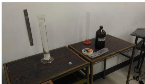
FIGURA 24 - EXPERIMENTO ANÁLISE DE VISCOSIDADE
