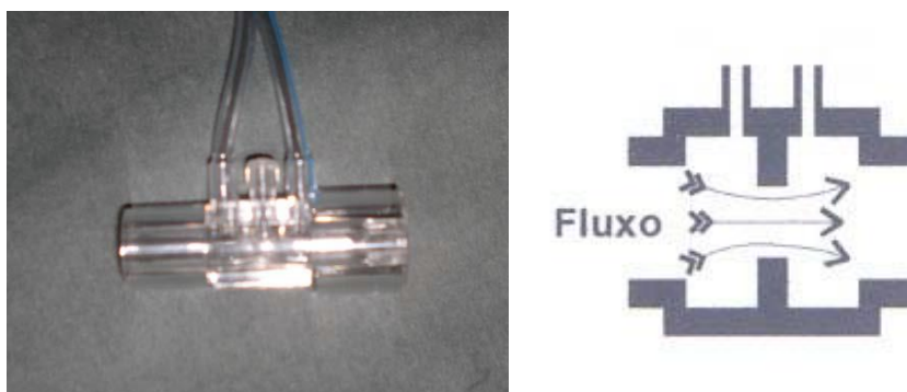
Figura 10: Sensor de fluxo do tipo pneumotacógrafo (diferencial de pressão). Fonte: Amendola, Castro e Azevedo (2007, p. 20).
