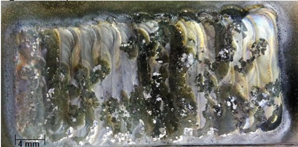
Figura 27 – Superfície recém revestida da Mistura 2.
